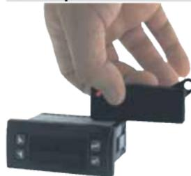
Ist der Regler nicht an die Versorgung angeschlossen: Die Speicherkarte besitzt eine interne Batterie, welche für ca. 1000 Übertragungen ohne Spannung ausreicht. Einstecken der Karte in die Pins und dann den Programmier-taster drücken.
