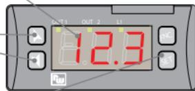
Schaltpunkte anzeigen (z. B. eingestellte Temperatur), einmal drücken für Set1 (Led Out1 blinkt), zweimal drücken für Set2 (Led Out2 blinkt). Im Konfiguration-Modus zusammen mit Pfeiltasten drücken zur Änderung des angezeigten Parameters.
